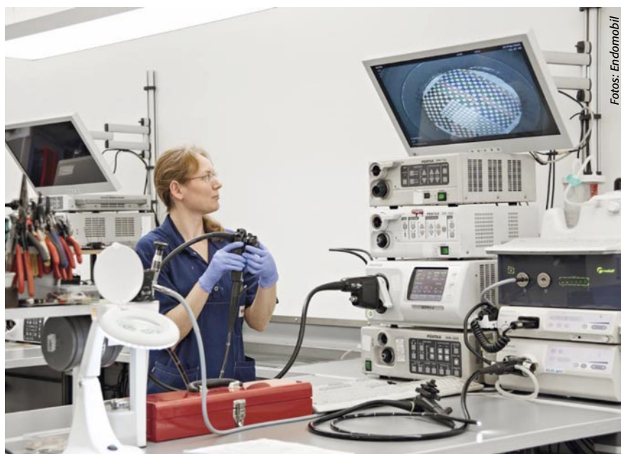
Bei der Kontrolle eines Videoendoskops wird das Bild überprüft.
