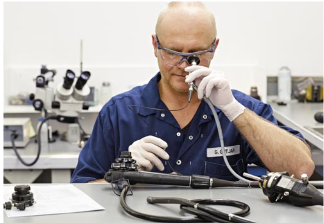
Überprüfung der Endoskope im Eincheck auf Schäden.
