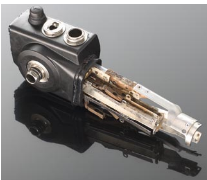
Kontrollkörper vor und nach der Reparatur.
