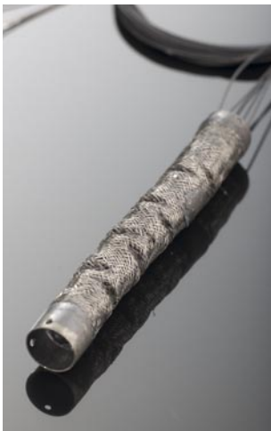
Abwinklungssektion mit Drahtgeflecht vor und nach der Reparatur.
