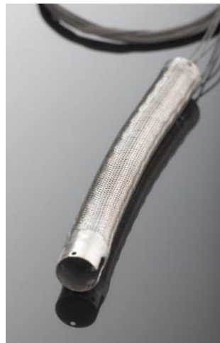
Abwinklungssektion mit Drahtgeflecht vor und nach der Reparatur.
